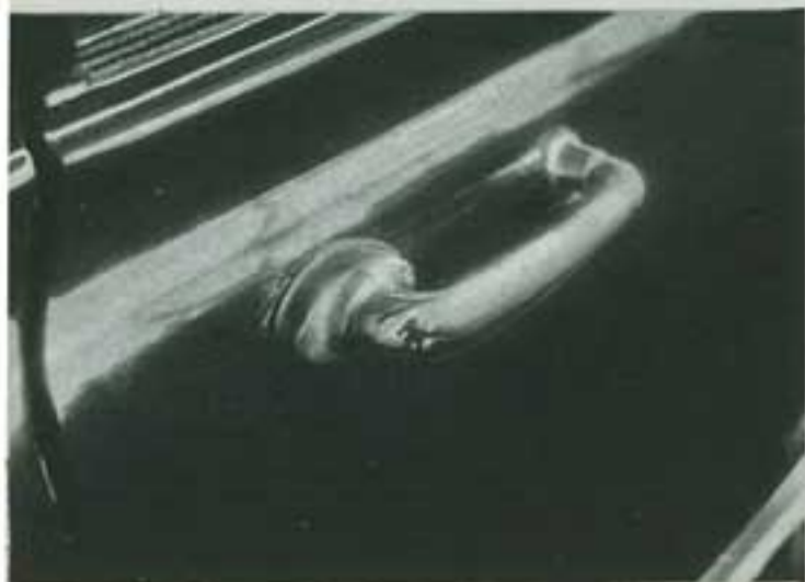
Le maniglie delle portiere già da qualche mese sono state dotate di un bottone di riscontro per evitare pericolosi agganciamenti.
