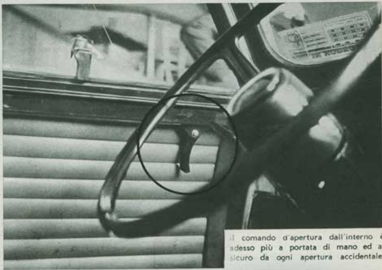
Le maniglie delle portiere già da qualche mese sono state dotate di un bottone di riscontro per evitare pericolosi agganciamenti.
