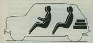
Massime condizioni di peso in esercizio: vettura completamente rifornita, quattro persone a bordo e kg. 40 bagaglio: kg. 965 dei quali kg. 477 (49,5%) all'avantreno e kg. 488 (50,5%) al retrotreno.
