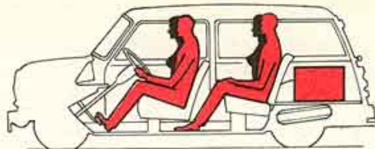
Massime condizioni di peso in esercizio: vettura completamente rifornita, quattro persone a bordo e kg. 40 di bagaglio: kg. 1010 dei quali kg. 490 (48,5 %) all'avantreno e kg. 520 (51,5 %) al retrotreno.
