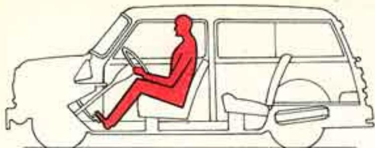
Minime condizioni di peso in esercizio: vettura parzialmente rifornita (metà serbatoio carburante) e solo guidatore: kg. 750 dei quali kg. 430 (57,3 %) all'avantreno e kg. 320 (42,7 %) al retrotreno.
