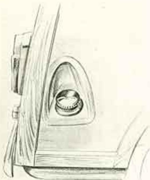
Particolare del bocchettone del serbatoio carburante alloggiato in una nicchia sul fianco destro posteriore.
