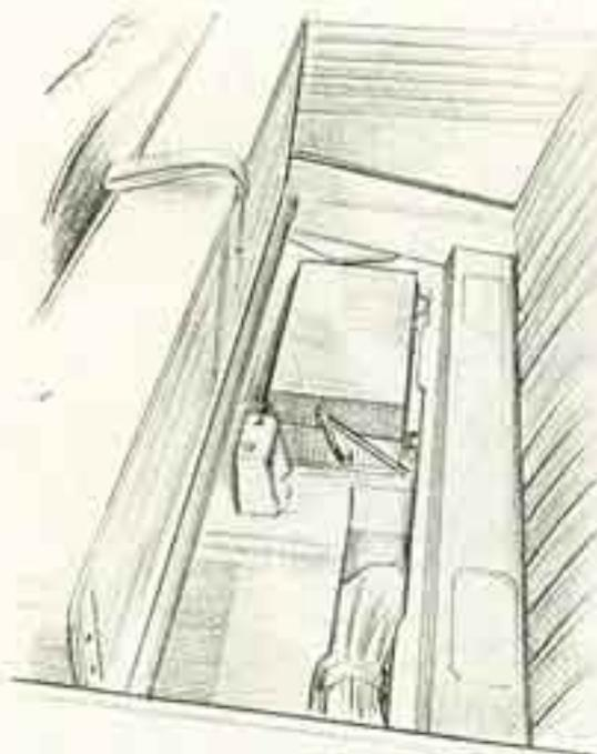
La batteria con gli attrezzi d'uso è sistemata sotto al piano del sedile posteriore.
