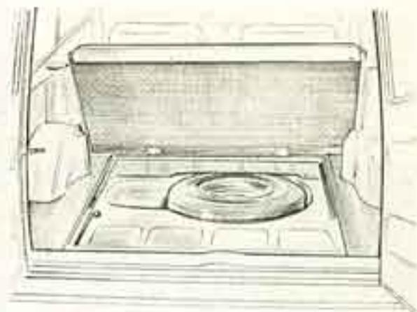
La ruota di scorta è sotto al piano di carico ed è ricoperta da un pannello mobile.
