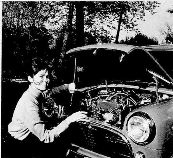
Buona l'accessibilità al motore, ed ai vari organi meccanici, grazie alla disposizione trasversale di esso. Molti modelli della B.M.C. adottano la particolare tecnica dal motore trasversale.
